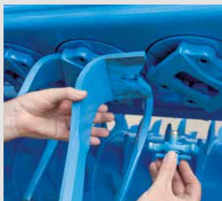
Szybka wymiana zęba tnącego
