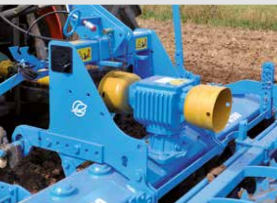
Proste przenoszenie mocy dzięki przekładni z wymiennymi kołami zębatymi
